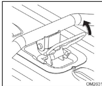
2. Abra el compartimento trasero, según señalado en la Figura arriba, levante la manija y vuelque el asiento hacia delante.
