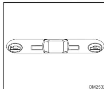
Sirve para seleccionar el modo de la entrada de aire fresco o de circulación de aire interior.
