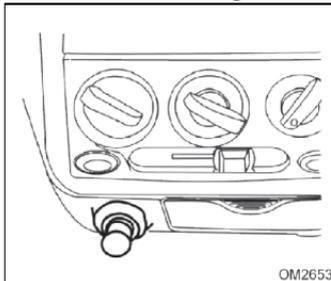
Cuando el interruptor de encendido esté en ON o ACC, presione el encendedor en su lugar y cuando esté suficientemente caliente, se expulsará de forma automática.
