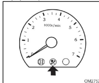
Después de arrancar el motor, el indicador encenderá por 4 segundos y enseguida apagará. En caso de que el indicador no encienda o esté apagado después de 4 segundos, o aún esté encendido con el vehículo en marcha, probablemente ocurrió una falla en el sistema de airbag. En este caso, el sistema de airbag no va a operar normalmente en caso de una colisión. Contacte a un Concesionario Autorizado Chevrolet.
