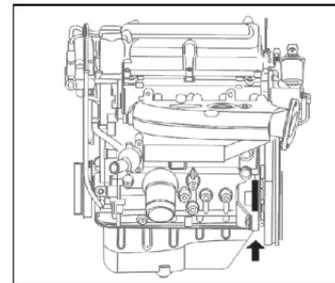
El número del motor está grabado en el lado derecho del tubo de escape del cuerpo del cilindro, según señalado por la flecha en la figura a continuación.
