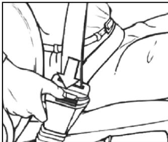
6. Para soltar el cinturón, presione el botón rojo (flecha). El cinturón se devolverá automáticamente.
