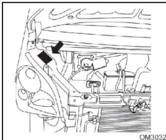
El VIN está marcado en la placa de identificación del vehículo que está remachada en el larguero dentro del compartimento del motor.
