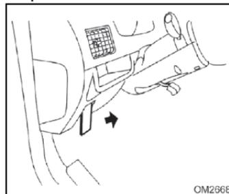
Para abrir el capó del motor, tire la palanca para destrabar el capó del motor; dicha palanca está ubicada en la parte inferior izquierda del tablero de instrumentos del vehículo.
