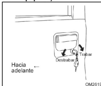
Sistema de cierre central – accionado a través de la puerta del conductor.
