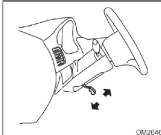
En cuanto al volante de dirección ajustable, se debe ajustar la posición antes de empezar a conducir. Se puede aún ajustar la posición de inclinación del volante de dirección, y al entrar o salir del vehículo, usted tendrá más espacio para las piernas.
