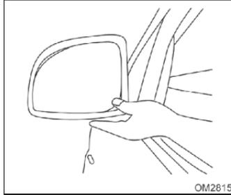
Presione los 4 extremos del espejo retrovisor exterior para lograr una posición adecuada al conductor, según lo señalado en la figura.
