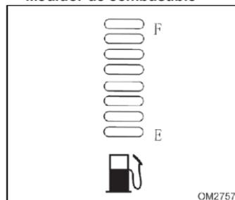
El medidor de combustible se utiliza para indicar la cantidad remanente de combustible en el tanque. Cuando el interruptor de encendido esté en OFF, el medidor de combustible seguirá indicando la posición corriente de combustible.
