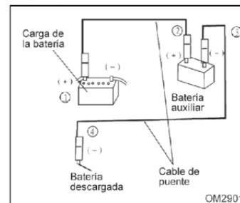
Si la batería de un vehículo estuviese descargada, es posible transferir la carga de la batería de un vehículo a otro.
