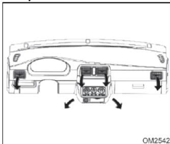
El flujo de aire viene de las entradas laterales y central y desde la parte inferior del tablero de instrumentos (según señalado en la figura). El aire es dirigido hacia el área del rostro y de los pies del pasajero.
