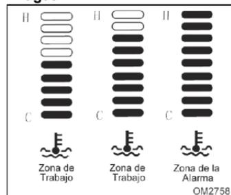
Cuando la llave de encendido esté en la posición ON, el medidor de temperatura del agua se utiliza para indicar la temperatura del líquido de enfriamiento.
