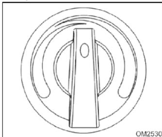
El interruptor de control de temperatura se utiliza para controlar la temperatura del aire alrededor de la entrada.
