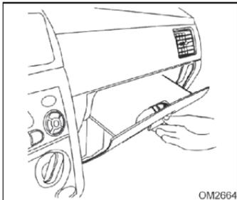
Para abrir la guantera, sujete la parte inferior de la traba de la guantera y tírela hacia arriba. Para cerrar la guantera, presione la tapa de la guantera con fuerza.
