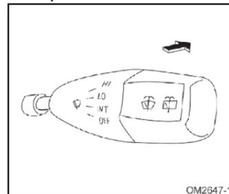
Para esparcir la solución del lavador sobre el parabrisas, el interruptor de encendido debe estar en la posición ACC; tire la palanca hacia el volante de dirección, según lo señalado en la figura.
