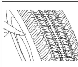
Por cuestiones de seguridad, se recomienda reemplazar los neumáticos cuando la profundidad de la banda de rodadura estuviese cerca de 3 mm.
