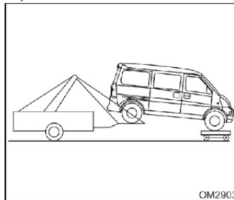
**Al remolcar el vehículo con las ruedas delanteras apoyadas sobre el piso**
