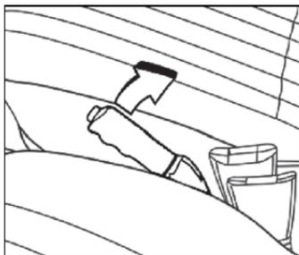
El freno de mano es mecánico y actúa solamente en las ruedas traseras. Se utiliza cuando el vehículo está detenido. Cuando aplique el freno de mano, la palanca se bloqueará automáticamente.
