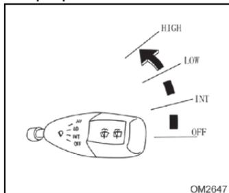
Para utilizar el limpiador de parabrisas, el interruptor de encendido debe estar en la posición ACC.
