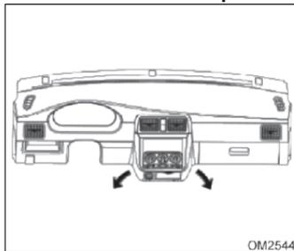
El flujo de aire está debajo del tablero de instrumentos, según señalado en la figura. El aire es dirigido al área de los pies del pasajero.
