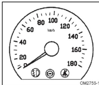
El velocímetro exhibe la velocidad del vehículo en kilómetros por hora (km./h).
