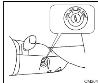
Para destrabar la columna de dirección, gire el volante de dirección ligeramente y ponga la llave de encendido en la posición ACC.
