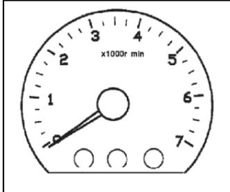
El tacómetro indica la revolución por minuto del motor RPM (para obtener el valor real, utilice la lectura, multiplicándola por 1.000).
