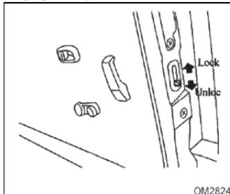
Suba el pestillo de seguridad bajo la cerradura de la puerta para que la puerta central pueda abrirse sólo desde afuera.
