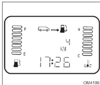
Cuando el tanque de combustible esté casi vacío, el indicador va a exhibir que es el momento de llenar el tanque del vehículo, según señalado en la Figura.
