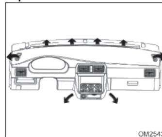
El flujo de aire viene de la parte inferior del tablero de instrumentos y entradas de desempañado del parabrisas y de los vidrios de las puertas delanteras (según señalado en la figura). El aire es dirigido al área de los pies de los pasajeros, parabrisas y vidrios de las puertas delanteras.
