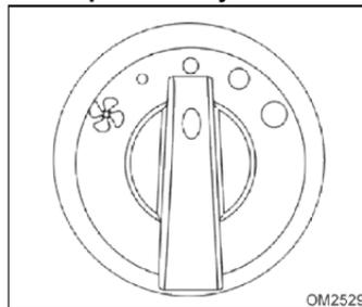
El interruptor de flujo de aire controla la velocidad del ventilador. (Hay cuatro posiciones de velocidad del ventilador.)
