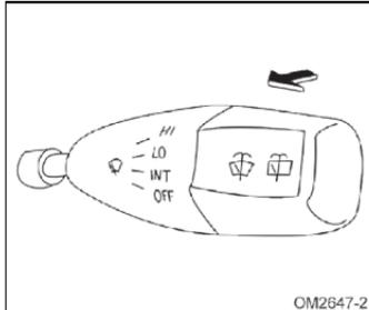
Para utilizar el limpiador y lavador de la luneta, el interruptor de encendido debe estar en la posición ON; tire la palanca hacia el tablero de instrumentos, según señalado en la Figura. Si estuviese desconectado, mueva la palanca del limpiador hacia el volante de dirección, posición central.
