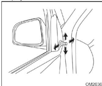
Ajuste el espejo retrovisor exterior de acuerdo con la posición requerida, utilizando la palanca, según lo señalado en la figura.
