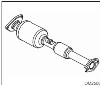
El convertidor catalítico del sistema de escape reduce los contaminantes indeseables, procesando los gases nocivos resultantes de la combustión.
