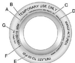
(A) Uso temporal únicamente: La llanta de repuesto compacta o de uso de temporal tiene una vida de dibujo de aproximadamente 5,000 kilómetros (3,000 millas) y no debe conducirse con ella a velocidades superiores a los 105 kms/h (65 mph). La llanta de repuesto compacta es para uso en emergencia cuando la llanta normal ha perdido aire o se ha pinchado.
