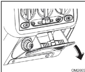
Si usa el cenicero, ábralo hacia afuera. Después de usarlo, empújelo de vuelta completamente.
