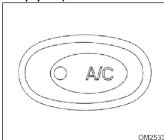
Este interruptor sirve para conectar y desconectar el sistema del acondicionador de aire. **Arranque el motor, gire el interruptor de flujo de aire hacia la velocidad deseada y presione el interruptor del acondicionador de aire para accionarlo.** Cuando el acondicionador de aire fuese conectado, la luz indicadora va a encender. Vuelva a presionar el botón para desconectar el acondicionador de aire y la luz indicadora va a apagarse.
