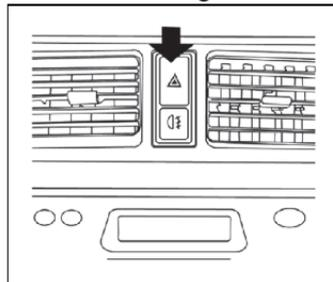
Al presionar el interruptor de la luz de emergencia, todas las luces señalizadoras de giro van a parpadear; al volver a presionarlo, todas las luces señalizadoras de giro van a apagar.
