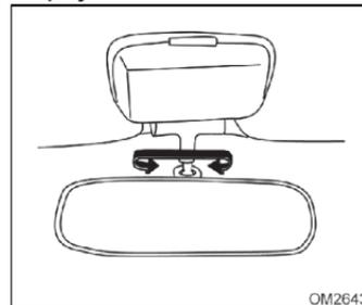
El conductor debe ajustar el espejo retrovisor interior y comprobar en cuanto a la posición correcta antes de empezar a conducir su vehículo de manera que pueda lograr la mejor visualización. Se puede girar el espejo retrovisor interior de acuerdo con la ilustración.
