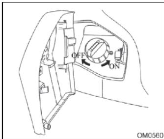
3. Gírela en sentido anti horario para abrir la tapa de llenado del tanque de combustible.
