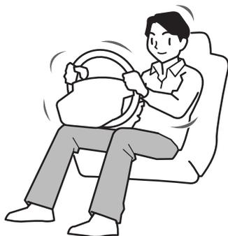
Sujete el volante con las dos manos y muévelo en la dirección del eje, así como arriba y abajo y hacia los lados para comprobar si hay flojedad.
