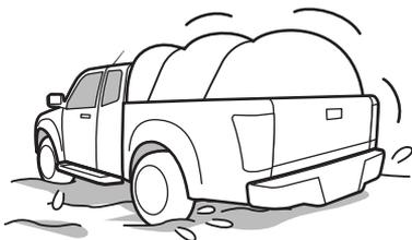
Cuando conduzca sobre arena o lodo, avance tan lentamente como sea posible, evitando frenadas bruscas, aceleraciones repentinas y giros cerrados con el volante de dirección.
