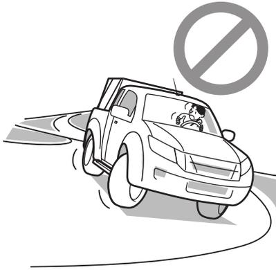
Quando realice un cambio de sentido en una pendiente pronunciada, el vehículo corre el riesgo de volcar cuando se sitúa en perpendicular con respecto a la pendiente. Conduzca con cuidado observando con detenimiento el estado de la superficie de la carretera para asegurarse de que los neumáticos en la parte más elevada de la pendiente no pisen ningún abombamiento de la calzada.
