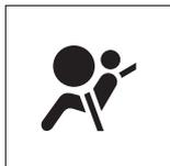
La luz de advertencia del airbag SRS debe parpadear siete veces cuando el interruptor de arranque se coloca en la posición "ON" y, a continuación, debe apagarse.
