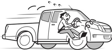
Si los frenos pierden eficacia inesperadamente, disminuya la velocidad reduciendo rápidamente las velocidades de una en una hasta llegar a 1ª. Tire gradualmente de la palanca del freno de estacionamiento mientras sostiene firmemente el volante de dirección y detenga el vehículo a un lado de la carretera. Tras detener el vehículo, póngase inmediatamente en contacto con el concesionario Chevrolet más cercano.
