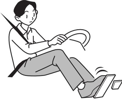
1. Asegúrese de que la palanca de cambio de velocidades está en la posición "N" y pise completamente el pedal del embrague (modelos de transmisión manual) y el freno de estacionamiento está firmemente engranado.
