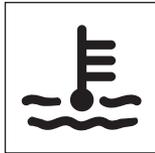
Con el interruptor de arranque en la posición "ON", este medidor indica la temperatura del refrigerante del motor. "C" significa frío y "H" significa caliente. Si el motor se sobrecalienta, se enciende la luz de advertencia de sobrecalentamiento del motor. Durante el funcionamiento, el medidor normalmente permanece dentro de la zona de seguridad.
