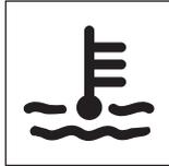
Esta luz de advertencia debe encenderse cuando se gira el interruptor de arranque a la posición "ON" y apagarse después de aproximadamente 3 segundos.
