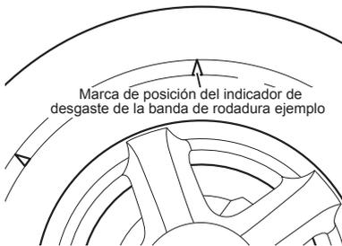
Indicador de desgaste de la banda de rodadura ejemplo
