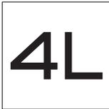
4. Cuando "4H" cambia a "4L", la luz indicadora de 4WD baja se enciende y cuando se cambia de "4L" a "4H", la luz indicadora de 4WD baja se apaga.
