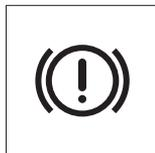
Aplique la palanca del freno de estacionamiento completamente cuando estaciona el vehículo. En el panel de instrumentos, se encenderá la luz de advertencia del freno de estacionamiento/sistema de frenos cuando se levante la palanca.
