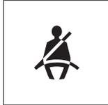
Esta luz de advertencia se enciende si el conductor no tiene abrochado el cinturón de seguridad cuando el interruptor de arranque está en la posición "ON".
