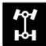
La luz indicadora de 4WD se enciende cuando se utiliza el interruptor 4WD para seleccionar "4H (4WD alta)" o "4L (4WD baja)".
