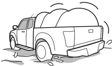
Cuando no pueda evitar conducir sobre lodo profundo, el uso de cadenas para neumáticos es una forma eficaz de evitar atascarse.
