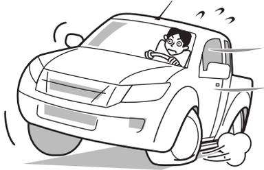
Cuando se pincha un neumático mientras está conduciendo evite frenadas bruscas, sostenga firmemente el volante de dirección y detenga el vehículo.
