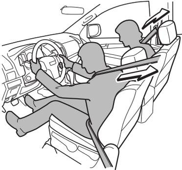
Cuando el vehículo recibe un impacto que excede un cierto nivel durante una colisión frontal o lateral (en modelos con airbag lateral y de cortina), el cinturón de seguridad abrochado se retrae instantáneamente y elimina la holgura del cinturón para sujetar de forma segura al conductor y al pasajero en el asiento, aumentando el efecto de sujeción del cinturón de seguridad.
