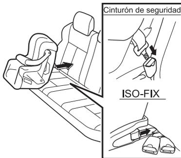
6. Fije el CRS al cinturón de seguridad o a ambos anclajes ISO-FIX. Consulte el manual de instrucciones del CRS.
