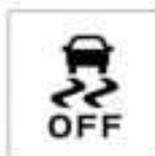
Cuando se coloca el interruptor de arranque en la posición "ON", la luz indicadora de desactivación de ESC se enciende y se apaga en aproximadamente 3 segundos. Si la luz indicadora se apaga el funcionamiento de desactivación de ESC es normal.
