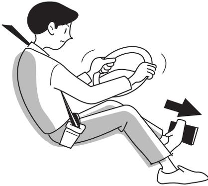
Debido a que el servofreno no funcionará, se reducirá la eficacia de los frenos. El sistema de dirección hidráulica no funcionará, por lo tanto será difícil girar el volante de dirección. Mantenga la calma y disminuya la velocidad del vehículo pisando el pedal del freno. A continuación, salga rápidamente de la carretera a un lugar seguro y revise su estado. Si el motor no arranca, póngase en contacto con el concesionario Chevrolet más cercano.
