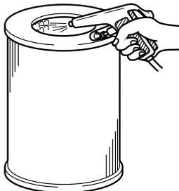
1. Aplique aire comprimido a una presión de hasta 690 kPa (7,0 kgf / cm<sup>2</sup> / 100 psi) contra el lado ascendente del filtro (modelos de motor 4JA1/4JJ1/4JK1) o en el interior del filtro mientras lo gira (modelo de motor Z24SED) para eliminar el polvo.
