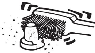
1. Compruebe que los terminales no presenten flojedad, grietas ni corrosión. Si el terminal presenta grietas, acuda a un Concesionario Chevrolet para que lleven a cabo una revisión y sustitución.
