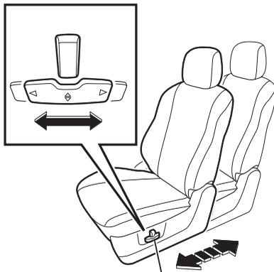
Palanca de ajuste de la altura y la posición hacia delante y detrás
