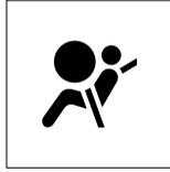
La luz de advertencia de airbag del SRS debe parpadear siete veces al girar el interruptor de arranque a la posición "ON", y a continuación, debe apagarse.
