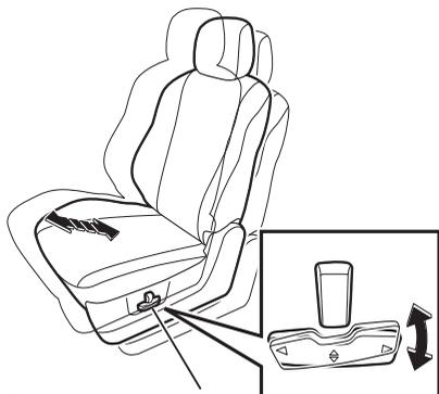
Palanca de ajuste de la altura y la posición hacia delante y detrás
