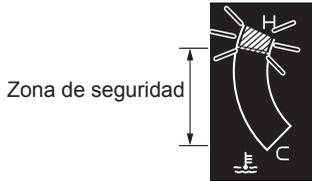
**Luz de advertencia de sobrecalentamiento del motor (modelos con MID)**
