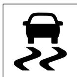
Cuando se gira el interruptor de arranque a la posición "ON", la luz de advertencia del ESC se enciende y se apaga en aproximadamente 3 segundos. Esta luz de advertencia se enciende siempre que haya un problema en el control electrónico de estabilidad (ESC). Cuando está en funcionamiento el ESC, esta luz de advertencia de ESC parpadea.
