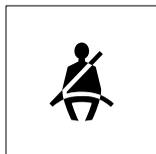
Esta luz de advertencia se enciende si el conductor no tiene abrochado el cinturón de seguridad cuando el interruptor de arranque está en la posición "ON".
