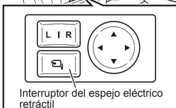
El interruptor del espejo eléctrico retráctil está activo solo cuando el interruptor de arranque está en "ACC" u "ON".
