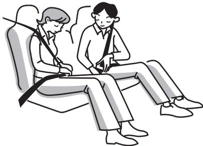
El cinturón de seguridad con pretensor y el sistema de airbags del sistema suplementario de sujeción (SRS) se activa en el caso de una colisión frontal, cuando la energía del impacto excede un cierto nivel, para ayudar a mitigar el impacto en el conductor y el pasajero sujetando firmemente el cuerpo del ocupante en el asiento con cinturón de seguridad delantero con pretensor y el airbag.
