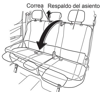
Es posible plegar el respaldo hacia adelante tirando de la correa. Antes de reclinar hacia adelante el respaldo del asiento, retraiga el cinturón de seguridad central trasero. Después de colocar nuevamente el respaldo del asiento en su posición original, conecte el cinturón de seguridad central trasero.
