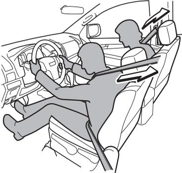
Cuando el vehículo recibe un impacto que excede un cierto nivel durante una colisión frontal, el cinturón de seguridad abrochado se retrae instantáneamente y elimina la holgura del cinturón para sujetar de forma segura al conductor y al pasajero en el asiento, aumentando el efecto de sujeción del cinturón de seguridad.
