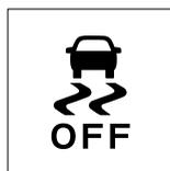
Quando se gira el interruptor de arranque a la posición "ON", la luz indicadora de desactivación del ESC se enciende y se apaga en aproximadamente 3 segundos. Si la luz indicadora se apaga, el funcionamiento de desactivación de ESC es normal.
