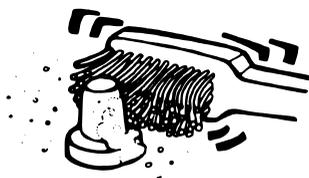
1. Compruebe que los terminales no presenten flojedad, grietas ni corrosión. Si el terminal presenta grietas, acuda a un Concesionario Isuzu para que lleven a cabo una revisión y sustitución.
