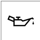
Esta luz de advertencia debe encenderse al girar el interruptor de arranque a la posición "ON", y después apagarse cuando el motor haya arrancado.
