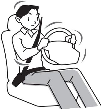
Sujete el volante con las dos manos y muévalo en la dirección del eje, así como arriba y abajo y hacia los lados para comprobar si hay flojedad.
