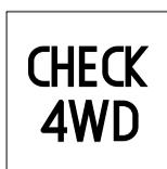
La luz de advertencia de CHECK 4WD se enciende al girar el interruptor de arranque a la posición "ON" y debe apagarse después de aproximadamente 3 segundos. Si esta luz de advertencia permanece encendida, el sistema de 4WD presenta una falla. Póngase en contacto con el Concesionario Isuzu más cercano.
