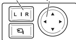
El interruptor de mando a distancia del espejo está activo solo cuando el interruptor de arranque está en "ACC" u "ON".
