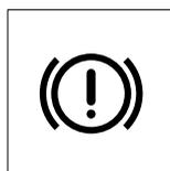
Cuando estacione el vehículo, aplique del todo la palanca del freno de estacionamiento, sin pulsar el botón de liberación. En el panel de instrumentos, se encenderá la luz de advertencia del freno de estacionamiento/sistema de frenos cuando se levante la palanca.
