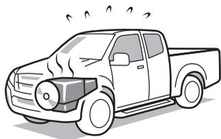
4. Compruebe el nivel del refrigerante de motor en el depósito de reserva y el radiador después de que el motor se haya enfriado lo suficiente. Si el nivel no es suficiente, añada refrigerante de motor. Además, compruebe si la correa del ventilador está floja o dañada.
