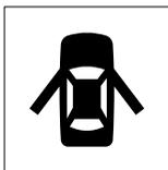
La luz de advertencia de puerta abierta se enciende si alguna puerta no está correctamente cerrada al girar el interruptor de arranque a la posición "ON".
