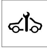
Esta luz indicadora debería encenderse al girar el interruptor de arranque a la posición "ON", y a continuación deberá apagarse después de arrancar el motor. Si la luz indicadora se enciende durante el funcionamiento, póngase en contacto inmediatamente con el Concesionario Isuzu más cercano para que realice una inspección.
