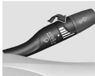
Palanca del limpiaparabrisas en la posición **INT**.
