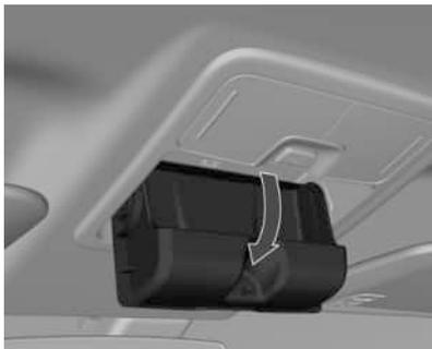
**Para abrirlo:** Empuje la parte trasera de la cubierta.
