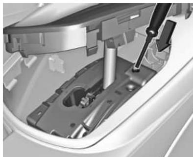
3. Inserte un destornillador en la abertura tanto como pueda introducirlo y saque la palanca selectora de la posición P. Si se engrana nuevamente P, la palanca selectora se bloqueará otra vez en su posición. Diríjase a un concesionario o taller autorizado Chevrolet tan pronto sea posible para verificar la falla y repararla.
