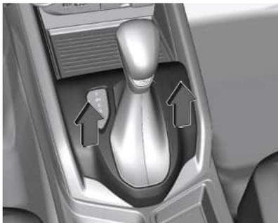
2. Presione la guarnición de la palanca selectora de la consola central en la parte trasera para liberarla, pliéguela hacia arriba y gírela a la izquierda.
