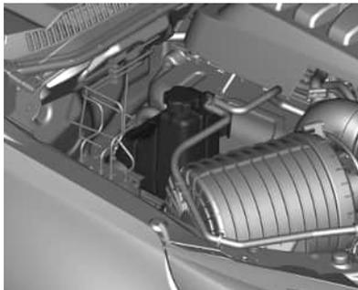
Si el sistema de refrigeración está frío, el nivel del refrigerante debe estar aproximadamente a 1 cm por encima de la marca de la línea de llenado. Rellene si el nivel es más bajo.
