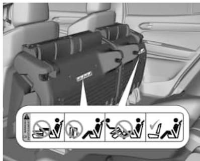
Las instrucciones para la posición de los asientos se muestra en una etiqueta en la parte trasera del asiento.
