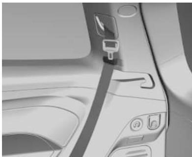
Guíe los cinturones de seguridad a través de sus soportes para asegurarse de que los asientos de la tercera fila no se atasquen al ser desplegados.
