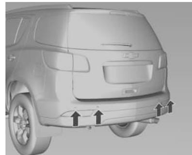
La asistencia para estacionamiento facilita el estacionamiento midiendo la distancia entre el vehículo y los obstáculos, y emitiendo señales acústicas. Sin embargo, esto no exime al conductor de su responsabilidad en la maniobra de estacionamiento.
