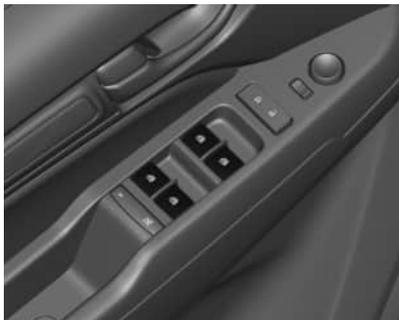
Accione el interruptor de la ventana correspondiente pulsando para abrir o tirando para cerrar. El interruptor de la ventana del conductor tiene una luz que indica, por medio de la iluminación, si está listo para ser accionado.
