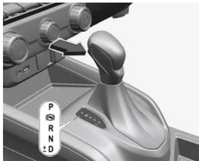
**P:** posición de estacionamiento, las ruedas están bloqueadas, solo se debe engranar con el vehículo detenido y el freno de estacionamiento aplicado
