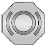
El tapón del depósito de líquido de frenos/embrague hidráulico tiene este símbolo. El depósito del líquido de frenos/embrague común se llena con líquido de frenos DOT 4LV, tal como se indica en el tapón del depósito. Vea la ubicación del depósito en *Vista del compartimento del motor* ⇨ 216.
