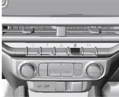
Si está equipado, LDW puede ayudar a evitar los choques debidos a un abandono no intencional del carril. Puede generar un alerta si el vehículo está cruzando un carril sin usar la señal de giro en esa dirección. La LDW utiliza una cámara para detectar las marcas de carril a velocidades de 56 km/h (35 mph) o superiores.
