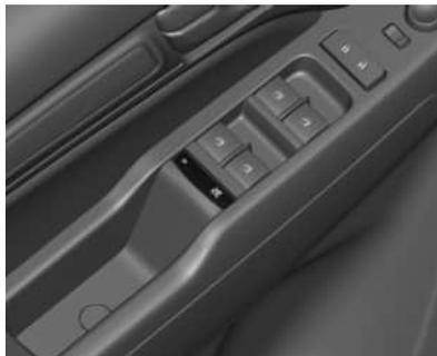
Pulse el interruptor
