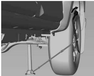
Si el neumático desinflado está en la parte trasera, coloque el gato debajo del eje trasero y lo más cerca posible del amortiguador.
