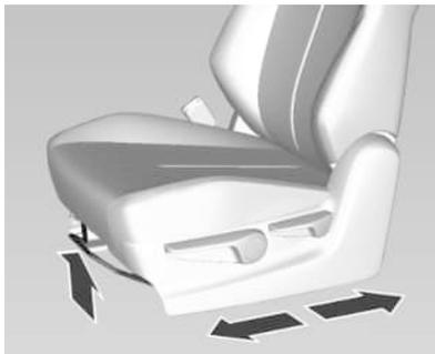
Tire de la palanca, deslice el asiento, suelte la palanca. Intente mover el asiento hacia delante y atrás para asegurarse de que el asiento está trabado en su lugar.
