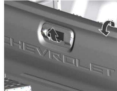
Para abrirlo, tire de la manija central y baje el portón. Para cerrarlo, levante el portón y presione los extremos superiores hasta que sienta un ruido de bloqueo.
