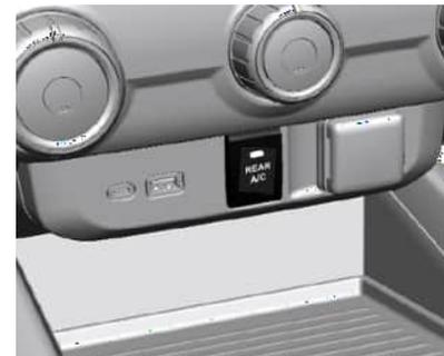
Si está equipado, el sistema de aire acondicionado trasero se acciona con el botón **REAR A/C** (A/A trasero).
