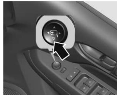
Pulse el interruptor selector (interruptor L/R) en la posición central, y luego pulse el interruptor de cuatro direcciones para plegar electrónicamente los espejos. Púselo nuevamente para desplegarlos.
