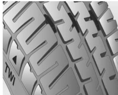
También deben sustituirse los neumáticos cuando el dibujo se haya desgastado a profundidad cercana a los 1.6 mm. La imagen muestra dónde se puede ver la profundidad del dibujo.
