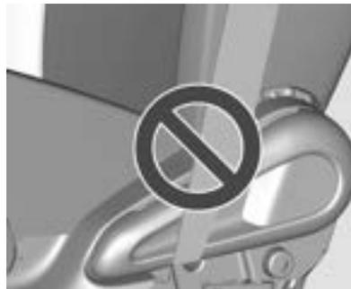
Asegúrese de que la cinta del cinturón de seguridad del asiento delantero esté instalada siempre en la posición correcta. La posición incorrecta de la cinta del cinturón de seguridad reduce la eficiencia de la protección del ocupante en caso de choque.
