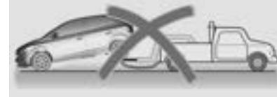
El remolque con dos de las ruedas levantadas del piso no es apropiado para este vehículo.
