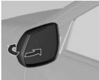
Para la seguridad de los peatones, los retrovisores exteriores basculan de su posición de montaje normal al recibir impactos de una determinada fuerza. Vuelva a colocar el retrovisor en su posición presionando ligeramente sobre la carcasa. Esta función también es útil para reducir el ancho total del vehículo y evitar daños cuando el vehículo está estacionado. Vuelva a colocar el retrovisor en su posición de funcionamiento antes de conducir.
