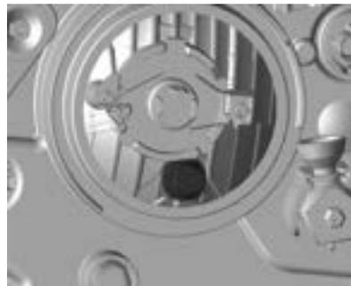
2. Retire la lámpara de la caja del reflector tirando de la lámpara y reemplácela por una nueva.
