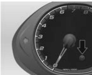
Pulse el botón de control situado en la lente del tablero de instrumentos para cambiar entre odómetro y odómetro parcial.
