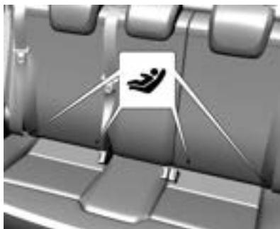
2. Localice la posición de los dos anclajes inferiores. La posición de cada anclaje inferior se identifica por una marca circular en el extremo inferior del respaldo del asiento trasero.
