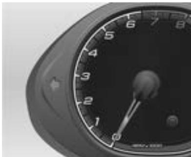
El tacómetro indica la velocidad del motor en revoluciones por minuto (RPM) (la lectura correcta se realiza multiplicando el número indicado por 1.000).
