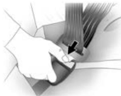
Para liberar el cinturón, pulse el botón del cierre. El cinturón de seguridad vuelve automáticamente a la posición original. Si es necesario, tire del cierre hacia abajo y luego suéltelo para permitir que el cinturón se retraiga totalmente.
