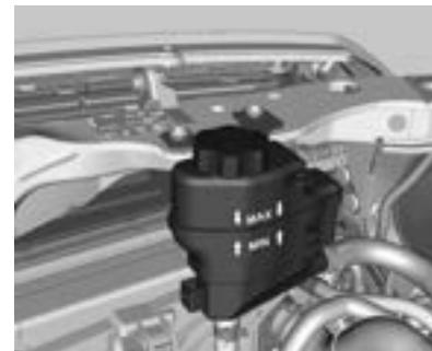
El nivel del líquido de la dirección asistida debe estar entre las marcas **MIN** y **MAX**.
