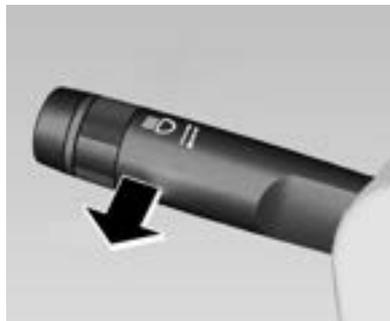
Para activar los guiños, tire de la palanca. La palanca volverá a la posición normal cuando la suelte. Las luces altas permanecerán encendidas mientras mantenga accionada la palanca.
