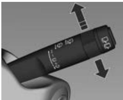
Si desea activar los limpiaparabrisas, coloque el encendido en la posición 1 y/o 2. Si desea activarlos de forma intermitente o continua, desplace la palanca de los limpia/lavaparabrisas hacia arriba. Si desea activarlos de forma manual, desplace la palanca hacia abajo. En esta posición la palanca vuelve a la posición inicial de forma automática.
