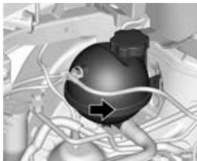
El tanque de compensación del refrigerante está ubicado en el compartimiento del motor, del lado del acompañante. Consulte *Vista del compartimento del motor (Motor turbo L3 1.0L)* ⇨ 168 o *Vista del compartimento del motor (Motor 1.0L L3)* ⇨ 170.
