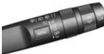
Empuje la palanca hacia adelante hasta la primera posición. El limpiavuneta comenzará a barrer. Para detener el movimiento, coloque la palanca en la posición inicial.
