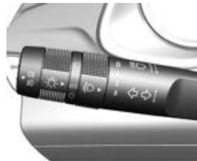
Para señalar un giro, mueva la palanca hacia arriba o hacia abajo, hasta el tope.
