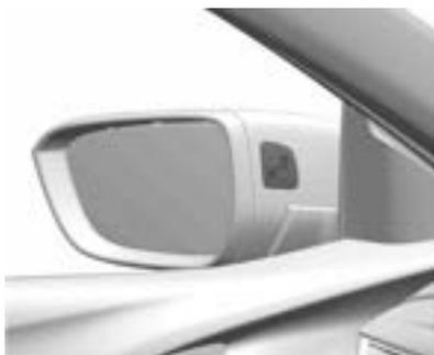
Cuando la velocidad del vehículo supera los 10 km/h, se activa el sistema de alerta del punto ciego lateral. Cuando la velocidad del vehículo es superior a los 140 km/h, se desactiva el sistema y se atenúan las luces indicadoras de los espejos derecho e izquierdo. En este punto, si se reduce la velocidad del vehículo, se apagan las luces indicadoras en los espejos. Si se detecta un
