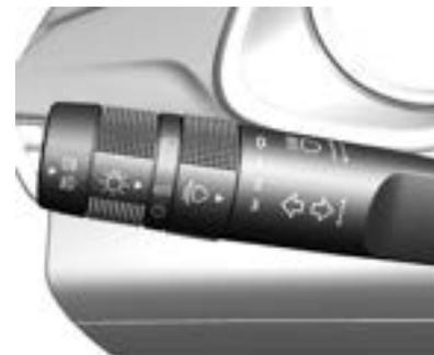
☰● : Con los faros encendidos, para encender la luz alta, empuje la palanca de las luces de giro hacia adelante y suéltela. Para volver a las luces bajas de los faros, empuje la palanca nuevamente o tirela hacia usted y suéltela.
