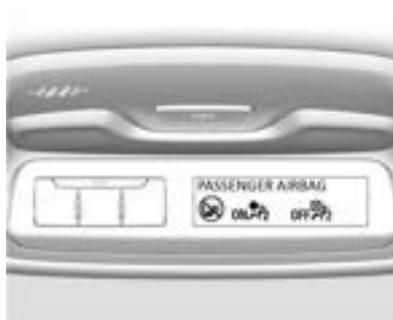
Siempre que el testigo de control **ON**
