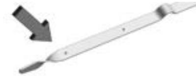
Si el aceite está por debajo del área con rayas cruzadas en la punta de la varilla de medición y el motor ha estado apagado como mínimo 15 minutos, agregue 1 L del aceite recomendado y luego vuelva a comprobar el nivel. Consulte "Selección del aceite correcto para el motor" más adelante en esta sección para ver la explicación acerca de la clase de aceite a usar.
