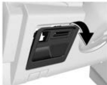
Caja de fusibles interior
