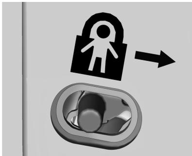
Si está equipada, la traba de seguridad se encuentra en los bordes interiores de las puertas traseras. Para utilizar la cerradura de seguridad:
