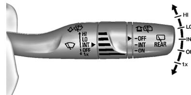
La palanca del limpia/lavaparabrisas está al costado de la columna de la dirección. Con el encendido conectado o en ACC/ACCESORY (ACC/ACCESORIO), mueva la palanca del limpiaparabrisas para seleccionar la velocidad del limpiaparabrisas.
