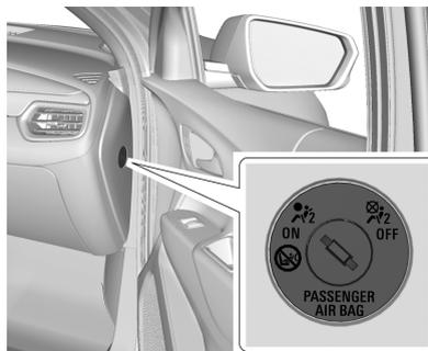
Use una llave para operar el interruptor. Vea *Interruptor de encendido/apagado de los airbags* ⇨ 89.
