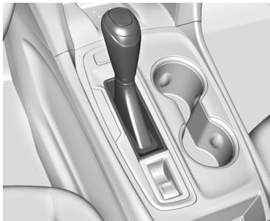
**P** : Esta posición bloquea las ruedas delanteras. Use P (Estacionamiento) al arrancar el vehículo ya que el vehículo no se puede mover fácilmente.
