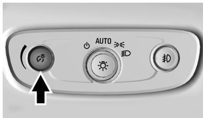
Se puede ajustar el brillo de la pantalla del cuadro de instrumentos, de la pantalla y los controles del infoentretenimiento, de los controles del volante y de todos los demás controles iluminados, así como los indicadores de estado de las funciones.
