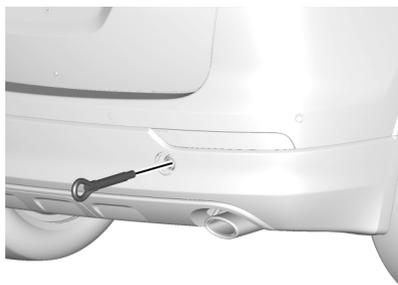
Coloque el anillo de remolque en el zócalo y gírelo hasta que quede completamente apretado.
