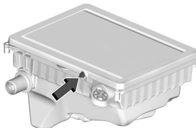
1. Alinee el filtro/depurador de aire con el punto indicado en la base de la carcasa del filtro/depurador de aire e instale el filtro/depurador de aire. La junta exterior del filtro/depurador de aire se debe colocar correctamente en la carcasa del filtro/depurador de aire.
