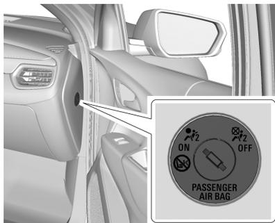
El airbag del acompañante delantero se puede desactivar por medio de un interruptor que se opera con la llave ubicado en el lado del acompañante en el tablero de instrumentos.
