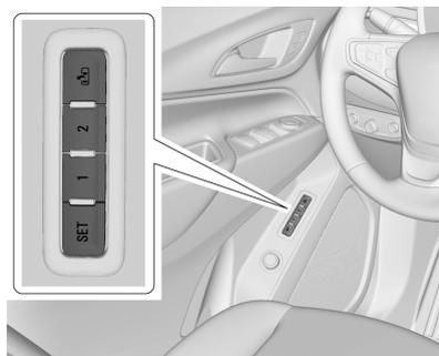
Si está equipado, la memoria de los asientos permite que dos conductores almacenen y recuerden sus respectivas posiciones de asiento para conducir el vehículo, y una posición de salida compartida para salir del vehículo. Las posiciones de memoria están vinculadas al transmisor RKE 1 o 2 para recuperar automáticamente los ajustes.
