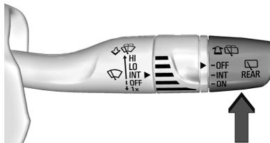
Gire el extremo de la palanca del limpiaparabrisas para operar el limpia/lavaluneta.
