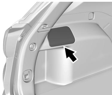
La caja de fusibles del compartimiento trasero está detrás de un panel de revestimiento, en el lado del conductor del compartimiento trasero.
