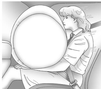
El airbag frontal del pasajero delantero exterior está en el lado del pasajero del tablero de instrumentos.
