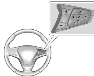
Pulse ◀ o ▶ para seleccionar el menú VEHICLE (VEHÍCULO), luego use ▲ o ▼ para desplazarse por los ítems del menú para seleccionar TCS/StabiliTrak.
