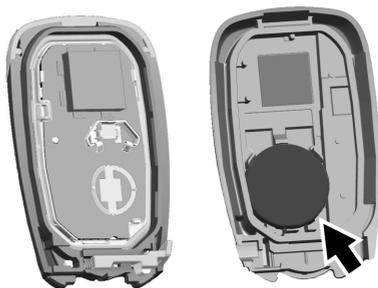
3. Saque la batería empujándola, y deslizándola hacia la parte de abajo del transmisor.
