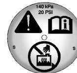
La tapa a presión del tanque de expansión de refrigerante se puede remover cuando el sistema de refrigeración, incluida la tapa a presión del tanque de expansión y la manguera superior del radiador ya no estén calientes.
