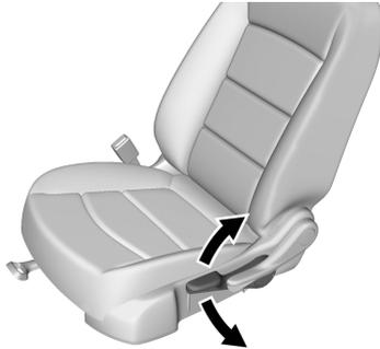
Mueva la palanca hacia arriba o abajo para elevar o bajar el asiento manualmente.
