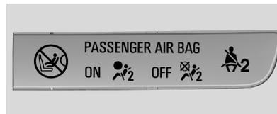
Si el vehículo tiene un interruptor que activa/desactiva el airbag, tiene también un indicador de estado de airbag de acompañante ubicado en la consola superior.
