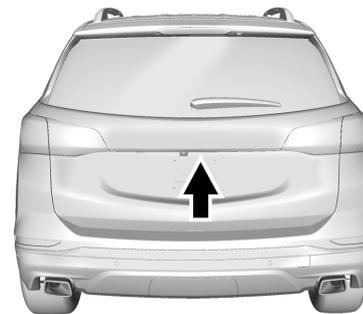
Para abrir la compuerta levadiza, presione el panel táctil debajo de la manija de la compuerta y levántela.
