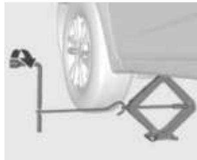
6. Al tener el gato en la posici n correcta, gire la llave para ruedas hasta que el neum tico est ecompletamente separado del piso, pero a no m s de 5 cm de distancia.
