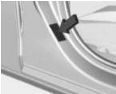
La placa de identificación se encuentra en la carrocería del vehículo, debajo de la puerta delantera derecha.
