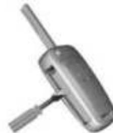
Use un destornillador plano con un ancho adecuado e insértelo en la pequeña ranura que se indica con una flecha en el gráfico para hacer palanca y abrirlo, luego de haber desplegado la llave.
