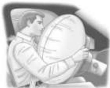
El airbag delantero del conductor está en el centro del volante.
