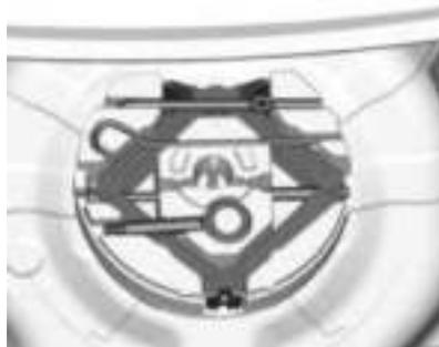
El gato, el anillo de remolque y las herramientas se encuentran en la caja de herramientas debajo de la rueda de auxilio en el compartimiento de carga.
