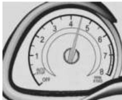
Muestra la velocidad del motor.
