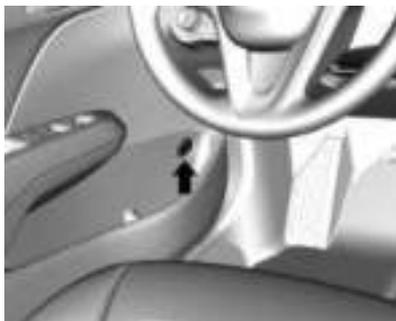
Pulse el botón en el panel de la puerta del conductor para abrir el baúl.
