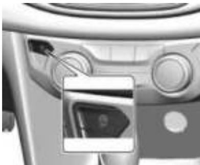
Pulse el bot n para desactivar manualmente el sistema de arranque/detenimiento autom/tico.
