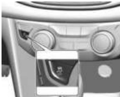
Para una conducción de muy alto rendimiento, se puede desactivar el ESC pulsando el botón a.
