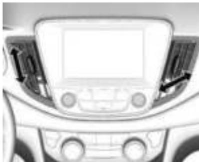
Mueva los deslizadores de las salidas de aire hacia arriba o abajo, o hacia la derecha o izquierda para dirigir el flujo de aire.
