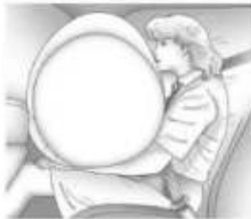
El airbag frontal del pasajero delantero exterior está en el lado del pasajero del tablero de instrumentos.
