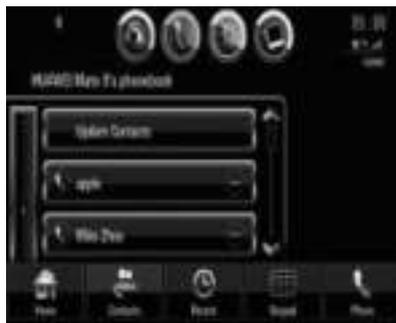
Esta interfaz de función muestra la libreta de direcciones. Toque el botón a la izquierda para marcar y toque el botón a la derecha para eliminar la información de los contactos almacenados en el sistema del vehículo. Toque sobre los nombres para ver la información detallada del contacto.
