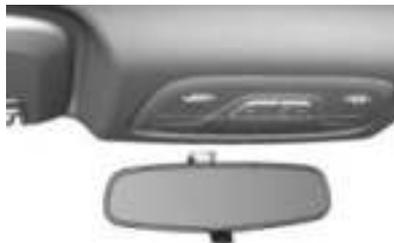
El espejo retrovisor interior se puede ajustar manualmente hacia arriba, hacia abajo, hacia la izquierda y hacia la derecha.
