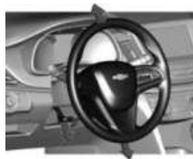
Desbloquee la palanca, ajuste el volante hacia arriba o hacia abajo a la posici n adecuada y luego enclave la palanca y asegúrese de que estØ completamente trabada.
