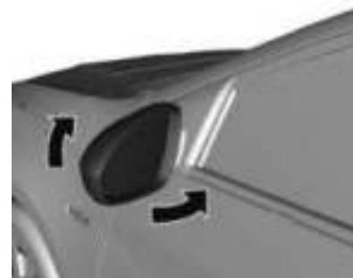
Los espejos se pueden plegar para evitar daos. Empuje el espejo retrovisor hacia afuera para devolverlo a su posici n original.
