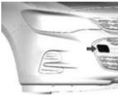
Abra cuidadosamente la tapa utilizando la ranura pequea que oculta el z calo del anillo de remolque delantero.
