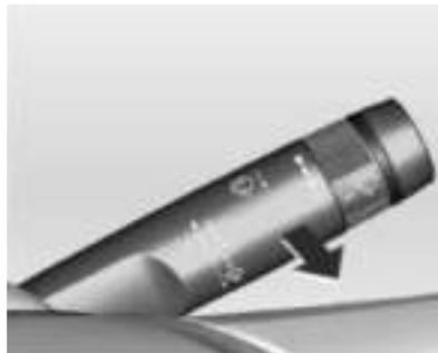
Tire de la palanca. El ruido de lavado se rocía en el parabrisas y los limpiaparabrisas realizan unos cuantos barridos.
