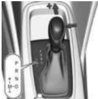
Mueva la palanca de cambios desde la posici n **D** hacia la izquierda y luego hacia delante o hacia atrs.
