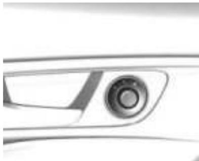
La perilla de control de los espejos elctricos estA ubicada junto a la manija interior de la puerta del conductor. Seleccione el espejo exterior correspondiente girando la perilla de control a la izquierda (L) o a la derecha (R). Luego, gire el control para ajustar el retrovisor.
