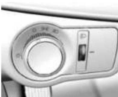
Ajuste el rango de iluminaci n de los faros basÆndose en la carga del veh culo, para evitar el encandilamiento: mueva la rueda de ajuste hacia arriba o hacia abajo a la posici n necesaria.
