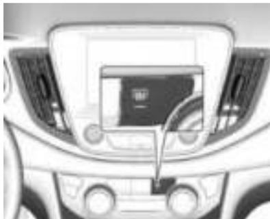
Pulse el botón
