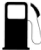
La luz de advertencia de bajo nivel de combustible se enciende inmediatamente cuando se pone en contacto el interruptor del encendido. Esto indica que el sistema está elevando a cabo una autoinspección y que la lámpara de la luz de advertencia está funcionando correctamente.
