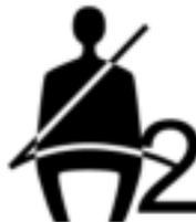
La luz de advertencia del cintur n de seguridad se enciende si el asiento del acompaante est ocupado y el ocupante no se ha abrochado el cintur n de seguridad correctamente luego de haber puesto en contacto el interruptor del encendido.
