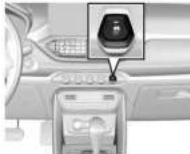
Pulse el interruptor ESC OFF después de arrancar el vehículo; se iluminará la lámpara ESC OFF del cuadro de instrumentos y algunas funciones ESC quedarán inhabilitadas. Presione nuevamente el interruptor ESC y se habilitará nuevamente la función ESC. La lámpara ESC OFF del cuadro de instrumentos se apagará
