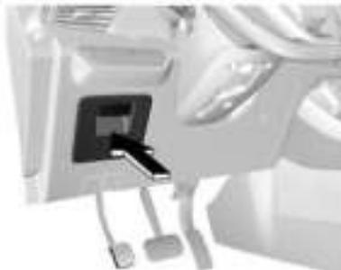
La caja de fusibles interior estÆ en la parte inferior izquierda del tablero de instrumentos y puede verse despuØs de sacar la caja de almacenamiento.
