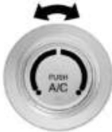
Se utiliza para controlar la temperatura del aire que fluye desde la salida del aire.
