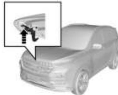
2. Una vez que se haya abierto un poco el cap , coloque su mano en el borde delantero más bajo del cap . Tire de la palanca de liberación del cap hacia arriba para abrir completamente el cap .
