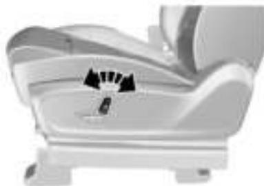
Gire el interruptor de ajuste hacia adelante o hacia atrás. El respaldo se inclinará hacia adelante o se reclinará hacia atrás. Suelte el interruptor cuando se haya alcanzado la posición adecuada.
