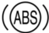
La luz de advertencia del ABS se enciende inmediatamente cuando se pone en contacto el interruptor del encendido. Esto indica que el sistema está elevando a cabo una autoinspección y que la lámpara de la luz de advertencia está funcionando correctamente. La luz de advertencia se apaga luego de varios segundos.
