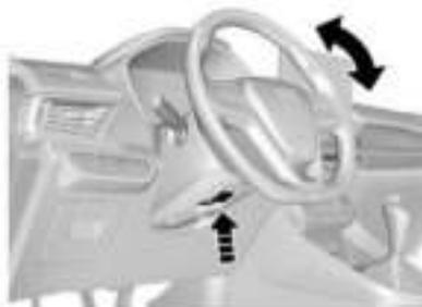
Ajuste el volante solo cuando el vehículo esté completamente detenido. El volante se puede inclinar hacia arriba y hacia abajo.
