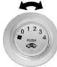
Gire la perilla de control de velocidad del ventilador para controlar el caudal de aire del sistema.
