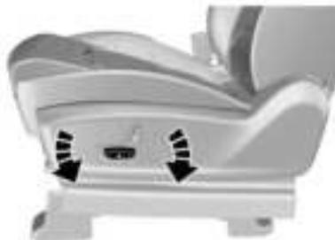
Tal como se muestra en la figura, gire el interruptor de ajuste de la altura que se encuentra en el lateral externo del cojín del asiento y suelte el interruptor cuando el asiento esté a la altura adecuada.
