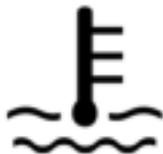
La luz de advertencia de la temperatura del refrigerante del motor se enciende cuando se pone en contacto el interruptor del encendido y se apaga después de varios segundos. Esto indica que tanto el sistema como la luz testigo están funcionando correctamente.
