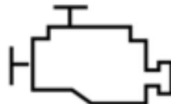
Esta luz testigo se enciende cuando se pone en contacto el interruptor del encendido pero no se ha arrancado el motor. Esto indica que la luz testigo está funcionando correctamente.
