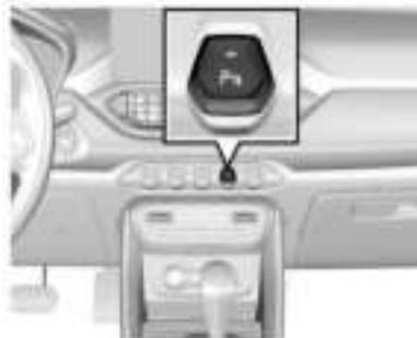
Si el vehículo está equipado con un interruptor de sistema de asistencia de estacionamiento, el indicador del interruptor se ilumina después de conectar la llave del encendido y presionar el interruptor de sistema de asistente de estacionamiento; si en este momento se suelta el freno
