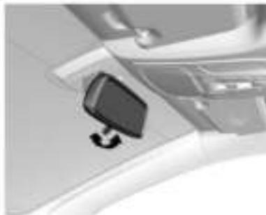
Ajuste manualmente el espejo retrovisor interior a un ángulo adecuado. El espejo retrovisor interior de algunos modelos cuenta con una función de antiencandilamiento que reduce el encandilamiento producido por las luces de los vehículos que le siguen detrás por la noche. Tire hacia adelante la lengüeta que está debajo del espejo retrovisor para activar el modo
