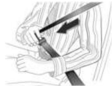
1. Tire del cinturón de seguridad para retirarlo del muelle y colóquelo cruzando el cuerpo sin retorcerlo.
