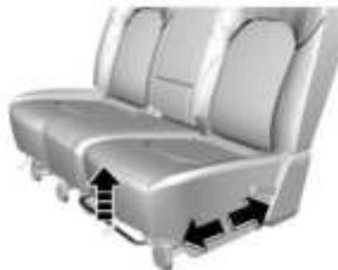
Para ajustar el asiento hacia adelante o hacia atrás, levante la palanca de ajuste que está en la parte delantera inferior del asiento. Suelte la palanca una vez que haya ajustado el asiento en la posición adecuada.
