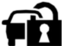
Este testigo se enciende cuando se abre una puerta. Se apaga una vez que arranca el motor. Esto indica que el testigo está funcionando correctamente.
