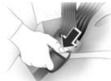
2. Coloque la placa de enganche en la hebilla para sujetar el cinturón. Tire de la banda superior para ajustar la tensión de la banda de la cadera.
