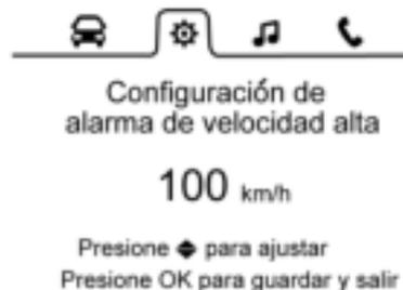
Ingrese a la visualización de ajuste de advertencia de sobrevelocidad para establecer el valor de velocidad en que se emitirá la advertencia. Cuando la velocidad de conducción excede el valor establecido, aparece un mensaje de
