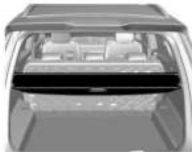
La cubierta se usa para proteger los objetos en el compartimiento de carga.
