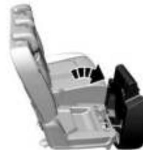
Luego de desbloquear el cojín, tire del mismo hacia afuera y levante la parte trasera del mismo para voltearlo. Se pueden voltear ambos cojines.
