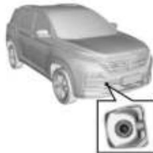
Hay una tapa de agujero en el lado derecho del paragolpes delantero del veh culo. ` bralo para acceder al orificio de fijaci n para colocar el gancho.
