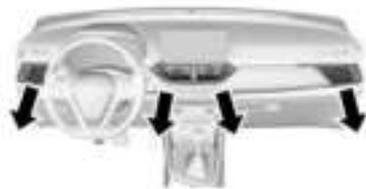
En este modo, el aire fluye desde la salida de aire central, la salida de aire lateral y la salida de aire de la consola.
