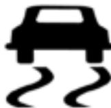
La luz de advertencia se enciende cuando se pone en contacto el interruptor del encendido y se apaga después de varios segundos. Esto indica que la luz de advertencia está funcionando correctamente.
