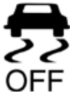
La luz de advertencia de StabiliTrak OFF (DESACTIVADO) se enciende cuando se pone en contacto el interruptor del encendido y se apaga después de varios segundos. Esto indica que la luz de advertencia está funcionando correctamente.
