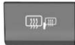
Para encender el desempañador, primero ponga en contacto el encendido y luego pulse el bot n del desempañador de la luneta trasera. El indicador del bot n se ilumina. Desactive el desempañador despu s de aclararse la visi n.
