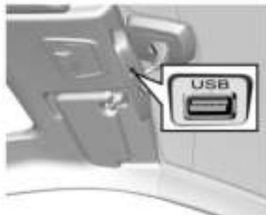
El conector se encuentra en la parte inferior del espejo retrovisor interior y puede proporcionar alimentación a su cámara de conducción.
