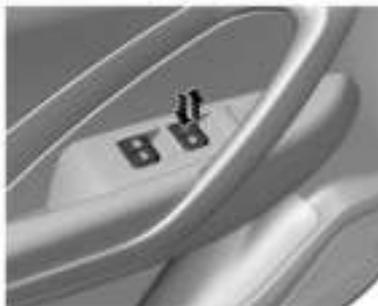
Para levantar el vidrio de la ventana, tire del interruptor hacia arriba.
