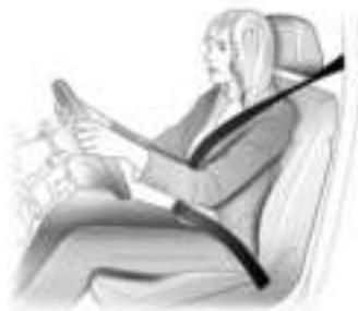
El cinturón de seguridad está diseñado para ser usado por un solo pasajero. Un pasajero menor de 12 años o de una estatura inferior a los 150 cm no debe sentarse en el asiento del acompañante delantero debido a las restricciones del cinturón de seguridad. Revise periódicamente todas las partes del sistema del cinturón de seguridad para verificar que no tenga daños y que no funcione de forma anormal.
