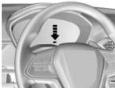
Una pulsación corta o larga del pestillo de ajuste cambia entre las distintas pantallas o restablece los valores a cero.
