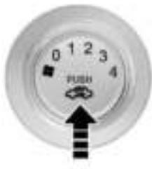
Presione este bot3n cuando conduce por una carretera polvorienta, o cuando desee evitar que entren gases de escape o humo del exterior, o cuando desee bajar o subir r3pidamente la temperatura en el compartimento de pasajeros. El indicador del bot3n se ilumina y el aire empieza a circular por el interior del veh3culo.
