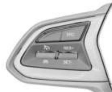
Los botones de control de velocidad crucero están en el volante. Cuando se inicia el sistema de control de velocidad crucero, el vehículo puede funcionar a la velocidad fijada. Pise el pedal de freno y la función será desactivada de inmediato. Los conmutadores de operación, tales como el freno de estacionamiento y el embrague, también pueden desactivar el sistema de control de velocidad crucero. El sistema puede ser utilizado en las marchas 3 (tercera), 4 (cuarta), 5 (quinta) y 6 (sexta) en
