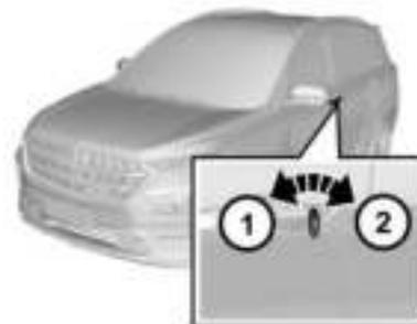
Para bloquear una puerta desde afuera con la llave, insértela y gírela hacia la derecha (2). Gire la llave hacia la izquierda para desbloquear la puerta (1).
