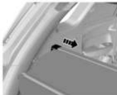
Presione los topes de ambos extremos del muelle de la cubierta de carga hacia el centro para quitar la cubierta de carga del vehículo.
