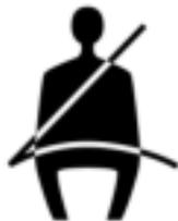
La luz de advertencia del cintur n de seguridad se enciende si el conductor no se abrocha el cintur n de seguridad correctamente luego de poner en contacto el interruptor del encendido.
