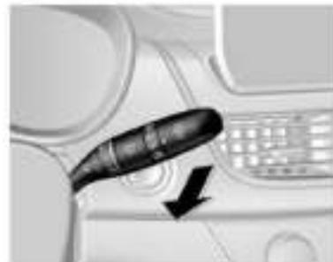
Para pulverizar l quido de lavado sobre el parabrisas:
