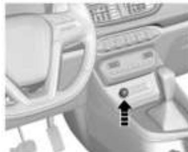
El encendedor de cigarrillos está instalado en la caja portaobjetos central del tablero de instrumentos.
