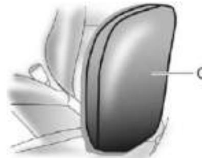
Tal como se muestra en la Figura C, el airbag lateral del asiento delantero se encuentra en el lateral del respaldo, del lado de la puerta.
