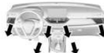
En este modo el aire fluye en dos direcciones. La mitad del aire fluye desde la salida de aire del piso y la salida de aire inferior del asiento delantero; el aire restante fluye desde la salida de aire central, la salida de aire lateral y la salida de aire de la consola.
