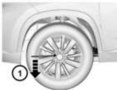
1. Extraiga las herramientas, el gato y la rueda de auxilio. Compruebe y confirme que la rueda en diagonal est escalzada con cuas, bloques o piedras.
