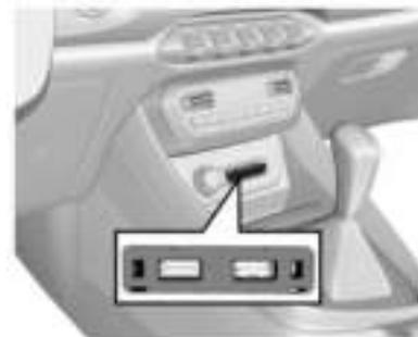
El toma de corriente para dispositivos de entretenimiento se encuentra debajo del panel de control del aire acondicionado.
