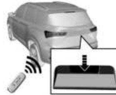
Cuando las puertas están bloqueadas y el interruptor del encendido está en la posición LOCK (BLOQUEO), acerque la llave a una distancia de 1,2 m de la manija de la compuerta levadiza. Presione el interruptor de liberación de la compuerta levadiza y el sistema se verificará con la llave. Una vez que se verifique correctamente, el sistema desbloqueará la compuerta levadiza y la misma se abrirá.
