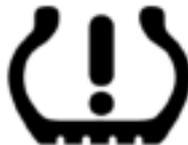
La luz de advertencia de la presión de los neumáticos se enciende cuando se pone en contacto el interruptor del encendido y se apaga después de varios segundos. Esto indica que la luz de advertencia está funcionando correctamente.
