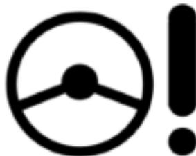
La luz de advertencia de la servodirección se enciende inmediatamente cuando se pone en contacto el interruptor del encendido. Esto indica que el sistema está elevando a cabo una autoinspección y que la lámpara de la luz de advertencia está funcionando correctamente. La luz de advertencia se apaga luego de varios segundos.
