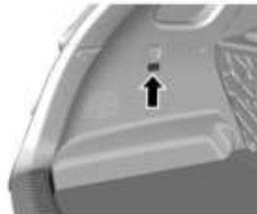
La luz del compartimento de carga se enciende cuando se abre la compuerta levadiza. Se apaga cuando se cierra la compuerta levadiza.
