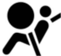
En el tablero de instrumentos hay una luz testigo de airbags que se distingue con el símbolo de los airbags. El sistema comprobará si el sistema de los airbags tiene una falla y el testigo le indicará si hay un problema. Consulte *Luz de alistamiento del airbag* ⇨ 82.
