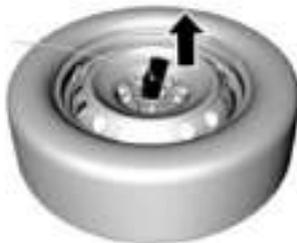
3. Incline la placa de sujeci n en el extremo de la cuerda de alambre y sAquele del agujero central de la rueda.
