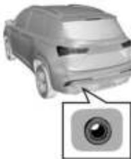
Hay una tapa de agujero en el lado izquierdo del paragolpes trasero del veh culo. `bralo para acceder al orificio de fijaci n para colocar el gancho.
