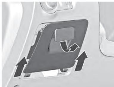
La caja de fusibles está detrás del compartimento portaobjetos en el tablero de instrumentos.
