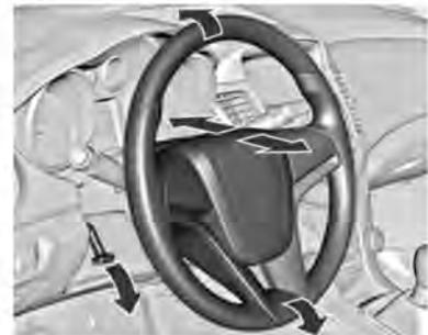
Desbloquee la palanca, ajuste el volante, luego asegure la palanca y asegúrese de que esté totalmente bloqueada. El volante sólo se debe ajustar con el vehículo parado y la dirección desbloqueada.
