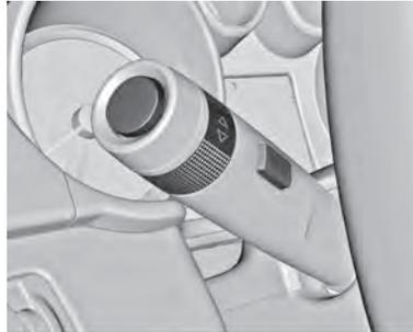
Pulse el botón **MENU** para cambiar entre menús o para volver de un submenú al siguiente nivel superior del menú.
