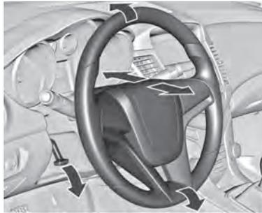
Desbloquee la palanca, ajuste el volante, luego sitúe la palanca y asegúrese de que esté totalmente bloqueada.
