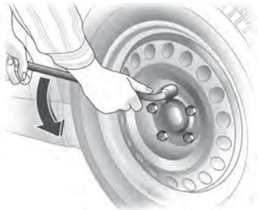
2. Despliegue la llave para llantas y móntela asegurándose de su correcta colocación y afloje cada tuerca de llanta media vuelta.
