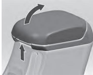
Presione la palanca para deslizar y levantar el reposabrazos.
