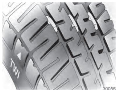
La profundidad mínima autorizada legalmente (1,6 mm) se ha alcanzado cuando el dibujo muestra un indicador de desgaste (TWI = Tread Wear Indicator). Su posición se indica mediante marcas en el flanco del neumático.
