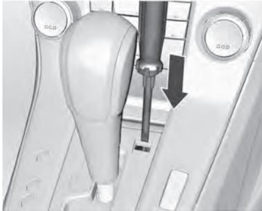
3. Inserte un destornillador en la abertura hasta el tope y saque la palanca selectora de la posición **P**. Si se selecciona de nuevo **P**, la palanca selectora volverá a bloquearse. Haga subsanar la causa de la interrupción de corriente en un taller.
