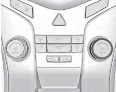
Gire el conmutador giratorio derecho. La velocidad del ventilador seleccionada se indica mediante el número en la pantalla.
