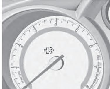
El testigo de control
