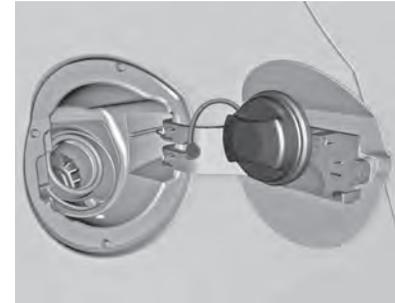
El tapón del depósito se puede enganchar en el soporte de la tapa del depósito de combustible.
