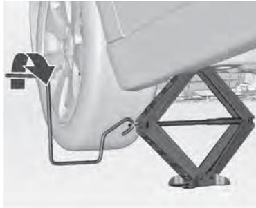
4. Ajuste la altura necesaria del gato antes de colocarlo debajo del punto de elevación, de modo que no pueda resbalar.
