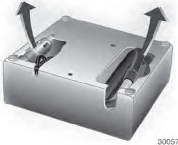
3. Saque el cable de conexión eléctrica y el tubo flexible de aire del compartimento portaobjetos en la parte inferior del compresor.
