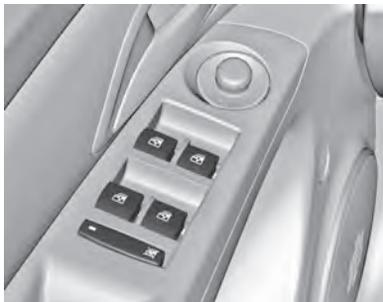
Pulse el interruptor
