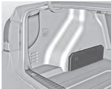
Guarde la cubierta del triángulo de advertencia con una cinta tipo velcro.
