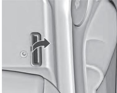
El número de identificación del vehículo está situado en el piso del vehículo, en el lado derecho, debajo de una tapa entre la puerta delantera y el asiento.
