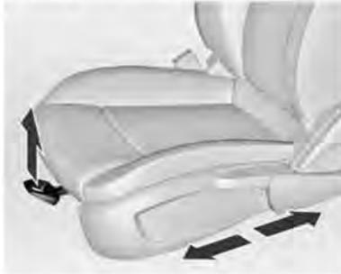
Tire de la palanca, deslice el asiento, suelte la palanca.
