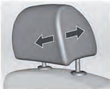
Para el ajuste horizontal, tire del reposacabezas hacia delante; se sitúa en 3 posiciones. Para colocarlo automáticamente en la posición atrásada, tire del reposacabezas hacia delante.
