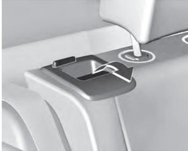
Tire de la palanca de desbloqueo en uno o ambos lados y abatir los respaldos sobre la banqueta de asiento. Antes de abatir los respaldos, introduzca los cinturones de seguridad de los asientos exteriores en las guías.
