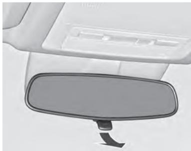
Para reducir el deslumbramiento, accione la palanca que hay debajo de la carcasa del espejo.
