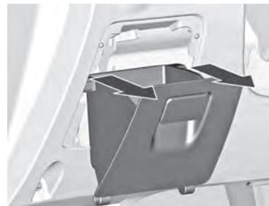
3. Desmonte el compartimento mediante las dos ranuras en la dirección de las flechas.
