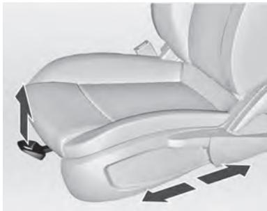
Tire de la palanca, deslice el asiento, suelte la palanca.
