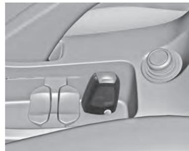
Abra la tapa en la parte inferior del portavasos de la consola central. Despliegue el paletón de la llave electrónica e insértelo en la ranura para la llave.
