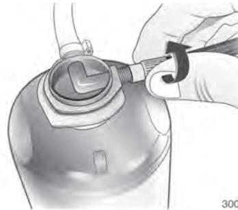
4. Enrosque el tubo flexible de aire del compresor a la conexión en el bote de sellador.
