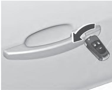
Desbloquee manualmente la puerta del conductor girando la llave en la cerradura. Conecte el encendido y pulse el botón del cierre centralizado
