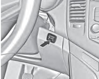
Pulse el botón **Start/Stop**. El encendido está conectado, lo que se indica mediante el LED amarillo en el botón. El inmovilizador electrónico está desactivado.
