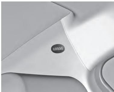
El sistema de airbags de cortina se compone de un airbag en el marco del techo a cada lado. Se pueden identificar por el rótulo **AIRBAG** en los pilares del techo.
