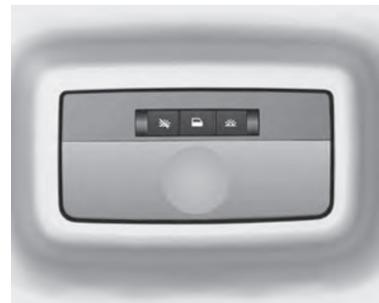
Al entrar y salir del vehículo, se encienden automáticamente las luces de cortesía, luego se apagan con un leve retardo. Se enciende brevemente aunque la llave se saque de la cerradura del encendido.
