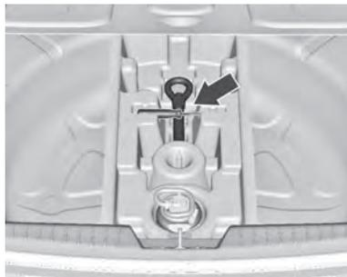
Las herramientas y el juego de reparación de neumáticos están en un compartimento portaobjetos debajo de la cubierta del piso en el compartimento de carga.
