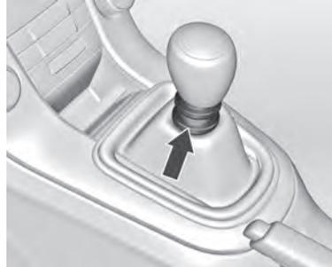
Para engranar la marcha atrás, con el vehículo parado, levante la anilla de la palanca selectora y engrane la marcha.
