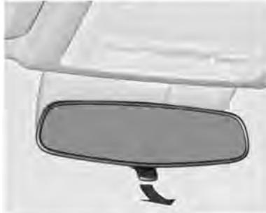
Ajuste la palanca en la parte inferior para reducir el deslumbramiento.
