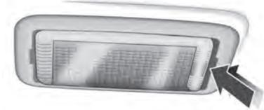
1. Extraiga la lámpara haciendo palanca con un destornillador.
