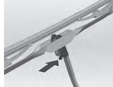
Levante el brazo del limpiaparabrisas. Mueva la palanca de desbloqueo y desacople la escobilla.
