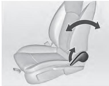
Tire de la palanca, ajuste la inclinación y suelte la palanca. Deje que el asiento asegure audiblemente.
