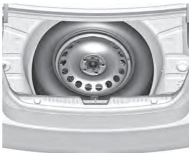
La llanta de repuesto está situada en el compartimento de carga, debajo de la cubierta del piso. Está fijada en el rebaje mediante una tuerca de mariposa.
