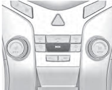
Pulse el botón **MODE** una o más veces para efectuar el ajuste deseado; el ajuste de la distribución de aire se indica en la pantalla de información.
