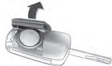
Despliegue la llave y abra la unidad. Sustituya la pila (tipo CR 20 32), prestando atención a la posición de montaje. Cierre la unidad y sincronice el mando a distancia.
