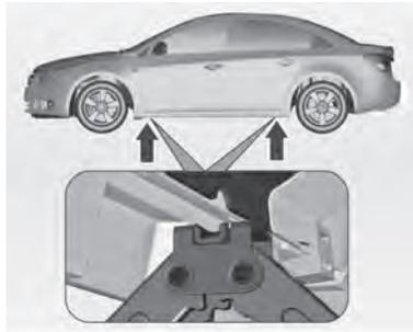
3. Asegúrese de que el gato esté correctamente colocado en los puntos de elevación del vehículo.
