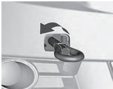
Enrosque la argolla de remolque todo lo posible hasta que quede en posición horizontal.
