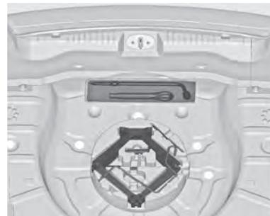
El gato y las herramientas están en un compartimento portaobjetos en el compartimento de carga, debajo de la llanta de repuesto. Llantas de repuesto ⇨ 156.
