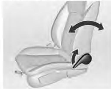
Tire de la palanca, ajuste la inclinación y suelte la palanca. Deje que el asiento se asegure audiblemente. No se apoye en el respaldo mientras lo ajusta.
