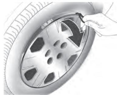
1. Desasegure los tapones de las tuercas de llanta con un destornillador y desmóntelos. Quite el tapacubos con el gancho. Herramientas del vehículo ⇨ 146.
