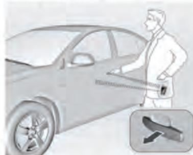
El usuario debe llevar consigo la llave electrónica. Tire de la manija de la puerta para desbloquear el vehículo y abrir la puerta. Para abrir la tapa del baúl, pulse el botón situado debajo de la moldura.
